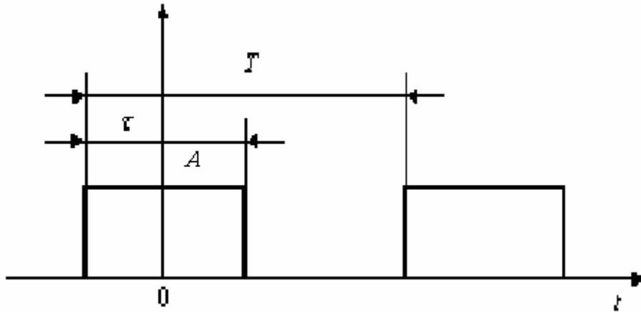
Рис.1.5. Периодическая последовательность прямоугольных импульсов.
