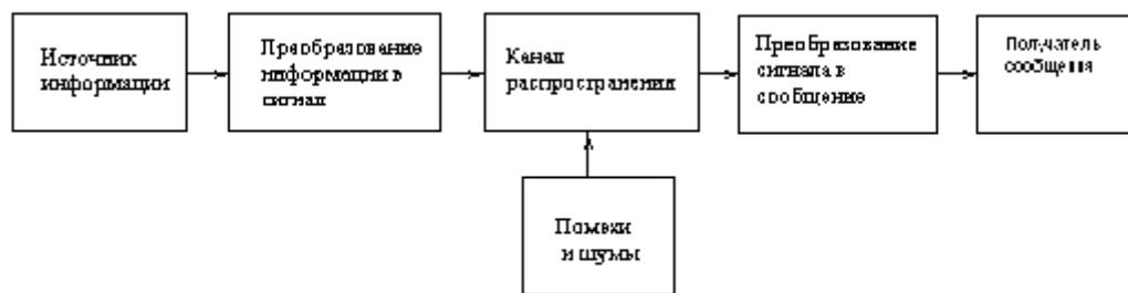
Рис. 1.1. Обобщенная структурная схема РТС.
