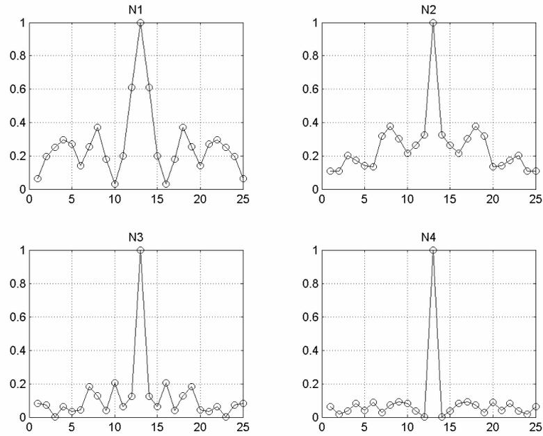
**Рис. 2. Выход «слепого» согласованного фильтра для различного числа импульсов в пакете:  $N1 = 5$ ,  $N2 = 15$ ,  $N3 = 45$ ,  $N4 = 95$  в отсутствии шума.**
