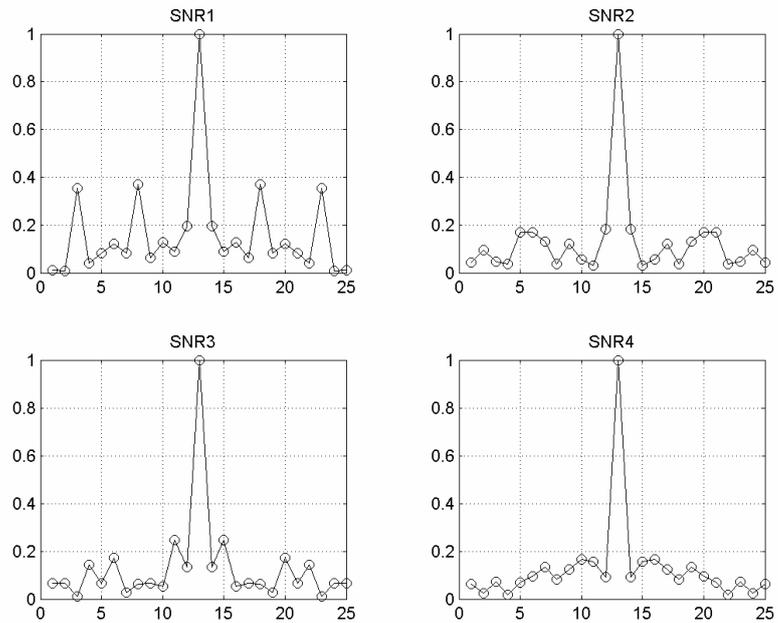
**Рис. 3. Выход «слепого» согласованного фильтра для  $N = 100$  и различного отношения сигнал-шум:  $SNR1 = 5$  дБ,  $SNR2 = 10$  дБ,  $SNR3 = 15$  дБ,  $SNR4 = 20$  дБ.**
