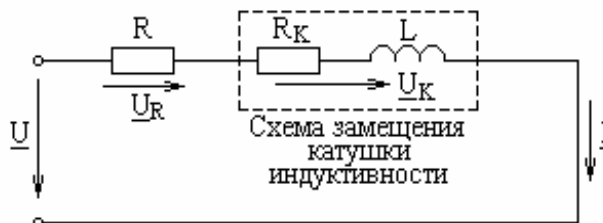
Рис. 2.4. Схема замещения последовательной \mathbf{RL} -цепи
