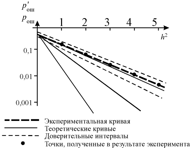
Рис. 3 – Пример построения кривых помехоустойчивости и доверительных интервалов
