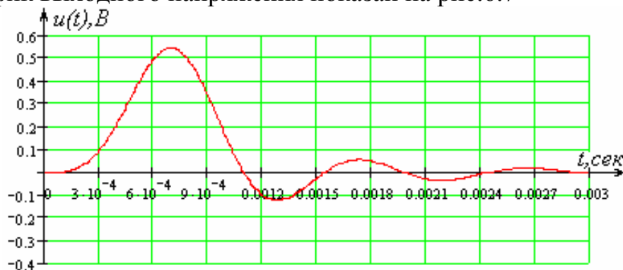
Рис.6.7 График зависимости выходного напряжения при подаче на вход прямоугольного импульса
