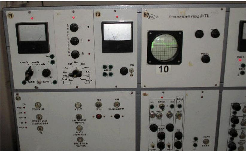
Генератор состоит из трех плат - Г1,Г2, Г3 (см. рис. 1.1).
