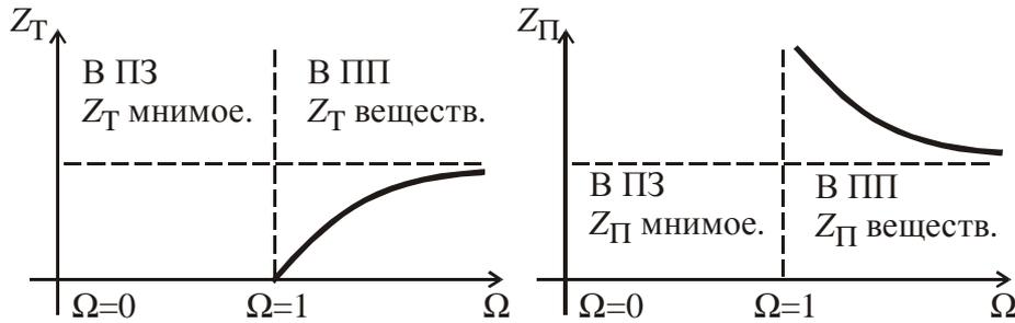
Полосовые фильтры (ПФ) типа «к». Частотные зависимости ослабления, фазы и характеристических сопротивлений.
