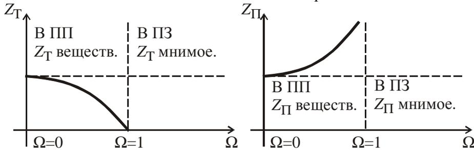
Фильтры верхних частот (ФВЧ) типа «к». Частотные зависимости ослабления, фазы и характеристических сопротивлений.
