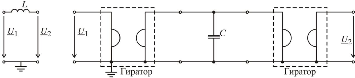
Представим схемы имитационных фильтров нижних и верхних частот:
