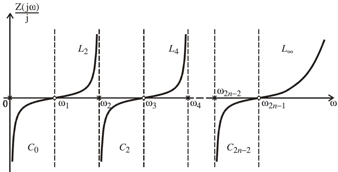
**II схема Фостера** представляется в виде параллельного соединения последовательных колебательных контуров:
