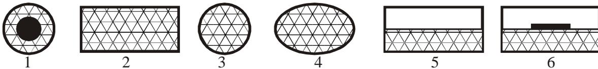
1 – коаксиальный кабель, 2 – прямоугольный волновод, 3 – круглый волновод, 4 – эллиптический волновод, 5 – частично-заполненный волновод, 6 – экранированная полосковая линия.
