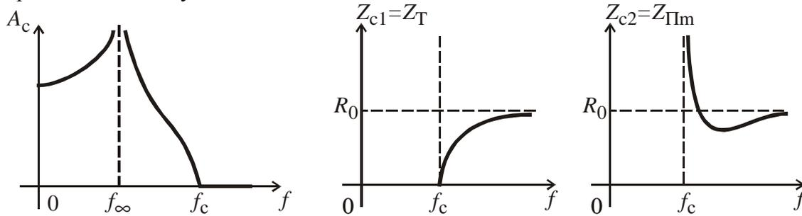
Параллельно-производное полувзено фильтра верхних частот (ФВЧ).
