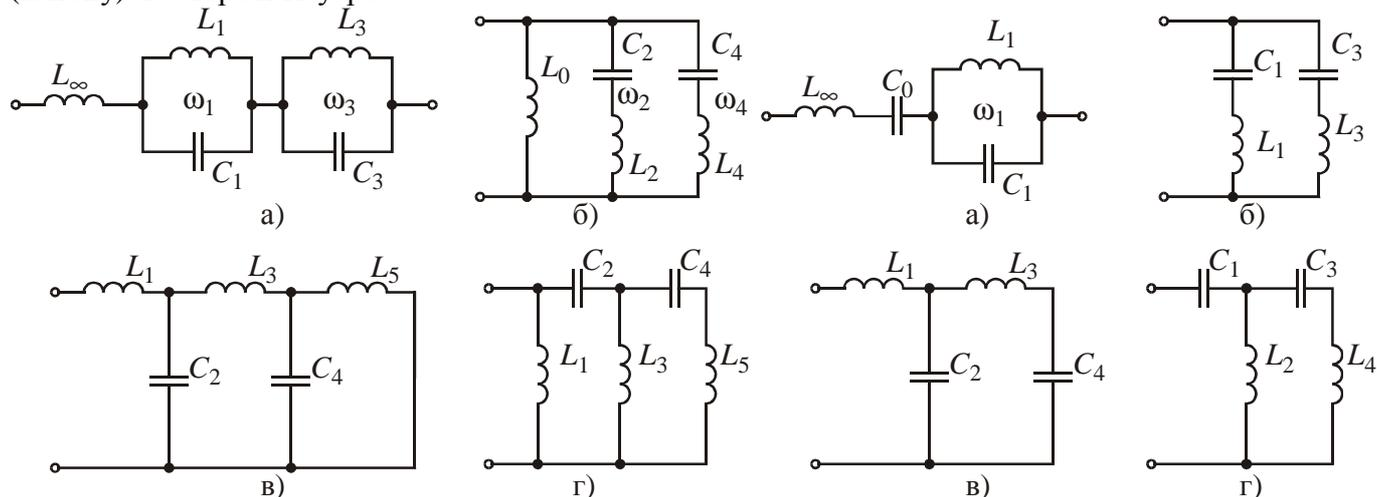
**I схема Фостера** представляется в виде последовательного соединения параллельных колебательных контуров:
