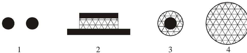
1 – двухпроводная линия, 2 – открытая полосковая линия, 3 – однопроводная линия, 4 – открытая диэлектрическая линия.
