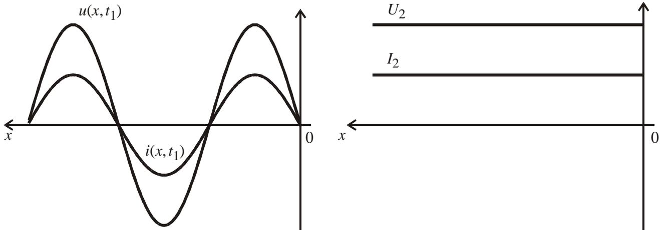
Линия без потерь. Режим короткого замыкания и холостого хода.
