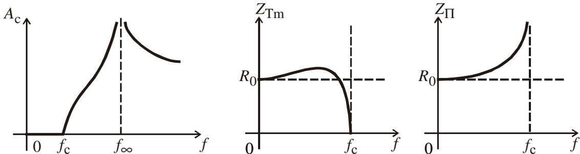
Производные ФВЧ типа «м». Частотные зависимости ослабления и характеристических сопротивлений.
